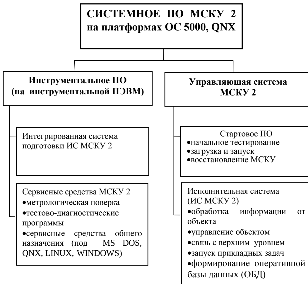
Рис. 3.10. Структура системного ПО МСКУ 2.
