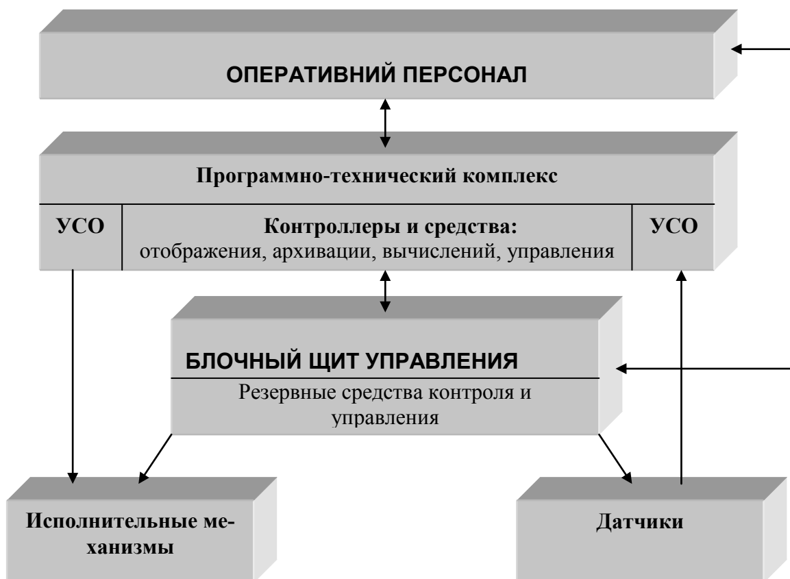
Рис. 1.1. Обобщенная структурная схема АСУ ТП.
