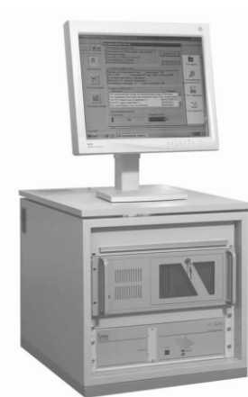
Рис. 2.30. Шкаф: размещение мониторов, системных блоков и сетевого оборудования.
