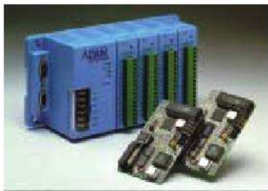
Рис. 2.9 Внешний вид микроконтроллера ADAM 5511.
