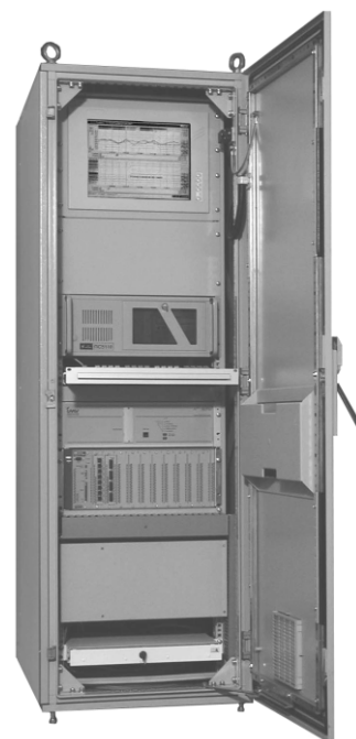
Рис. 2.30. Шкаф: размещение мониторов, системных блоков и сетевого оборудования.
