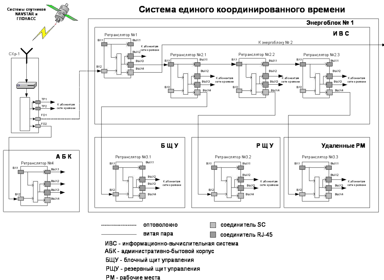
Рисунок 15 – Вариант реализации сети единого времени
