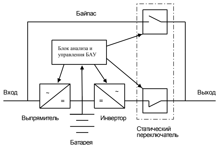
Рисунок 4 – Блок-схема УБП с двойным преобразованием энергии
